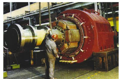
Schenkelgenerator bei der Läufermontage.
