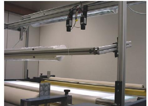
Anlage zur automatischen Textilinspektion.
