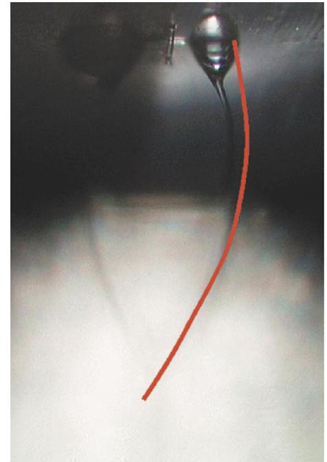
Abb. 2: Mikroskopaufnahme des Flüssigkeitsfilms. Die rote Kurve entspricht der Simulation.
